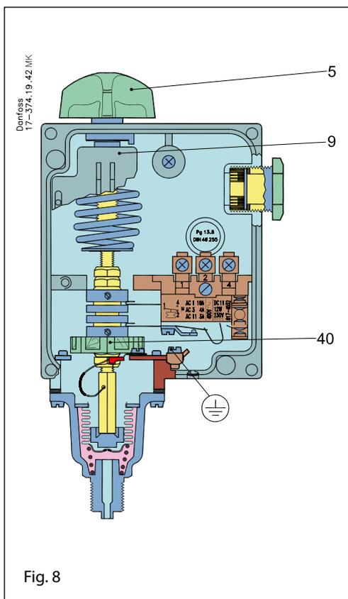
Los presostatos RT-L están provistos de un conmutador con zona neutra ajustable. Esto permite utilizar las unidades para control flotante. La terminología utilizada se explica a continuación.
