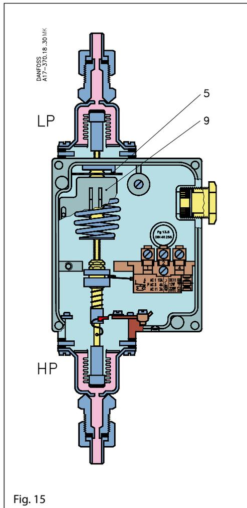
El disco de ajuste (5) es accesible al ser retirada la cubierta frontal. La presión diferencial se ajusta haciendo girar el disco con un destornillador al mismo tiempo que se observa la escala (9).
