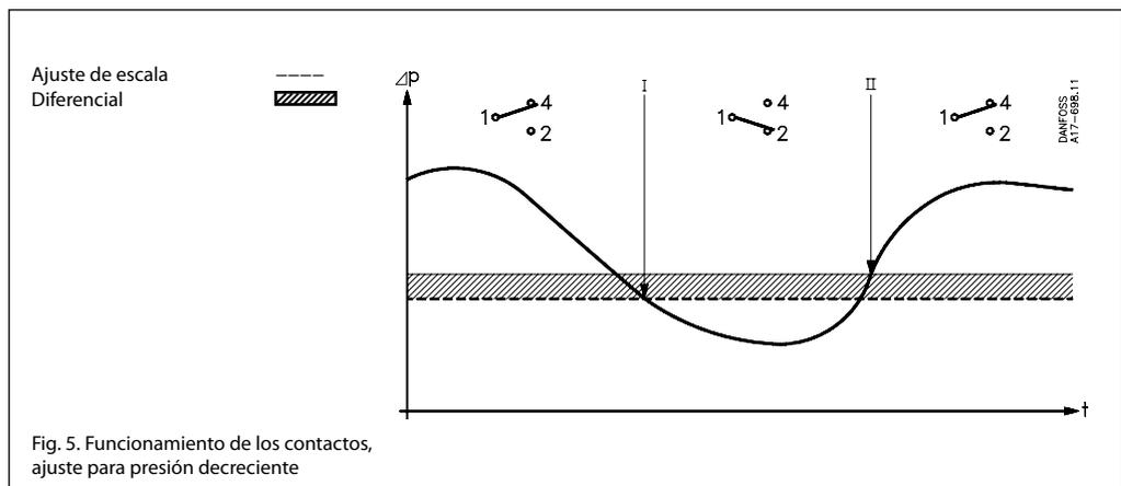
Fig. 5. Funcionamiento de los contactos, ajuste para presión decreciente
