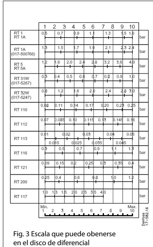
Fig. 3 Escala que puede obtenerse en el disco de diferencial
