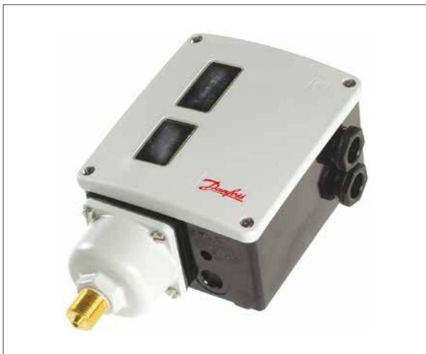
Los presostatos RT incorporan un conmutador inversor unipolar controlado por presión, donde la posición del contacto depende de la presión en la conexión de entrada y del valor ajustado en escala.
